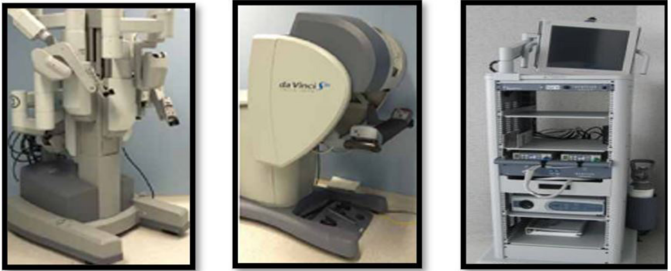
Figura 4: Componentes del sistema de cirugía robótica da Vinci. A. Carro del paciente. B. Consola del cirujano. C. Carro de vídeo
